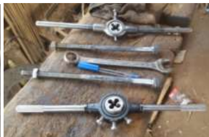
Photo n°8 : Filières de dimensions variables et autres instruments dans une forge à Bassila.
