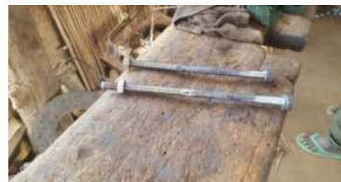
Photo n°6 : Boulons de ressort de camion poids lourd filés par le maître forgeron.
